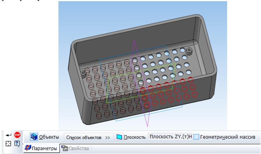
Рис. 2.14. Массив отверстий
