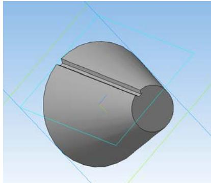
Рис. 3.11. Канавка накатки на ручке
