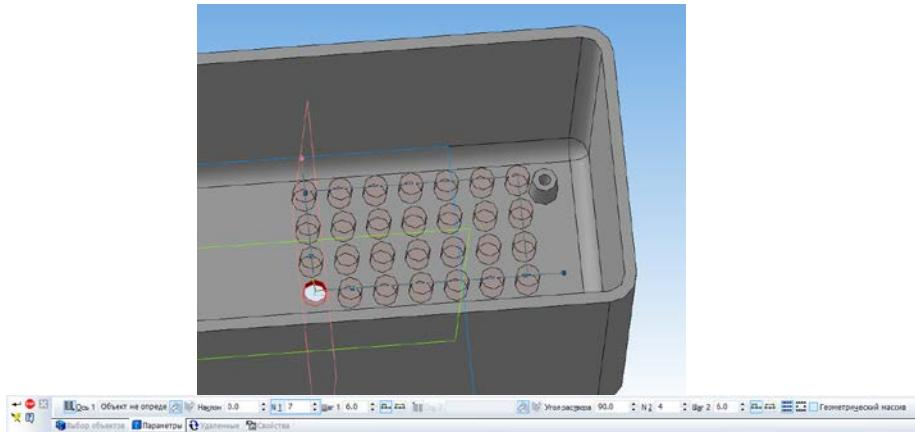
Рис. 2.13. Массив отверстий по сетке
