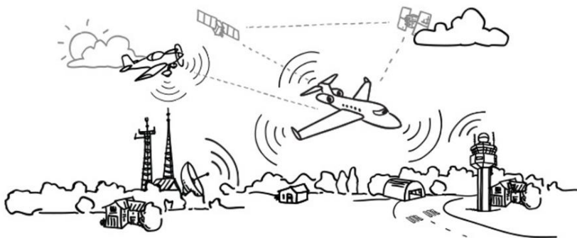
Рис. 22. Общий принцип работы технологии ADS-B
