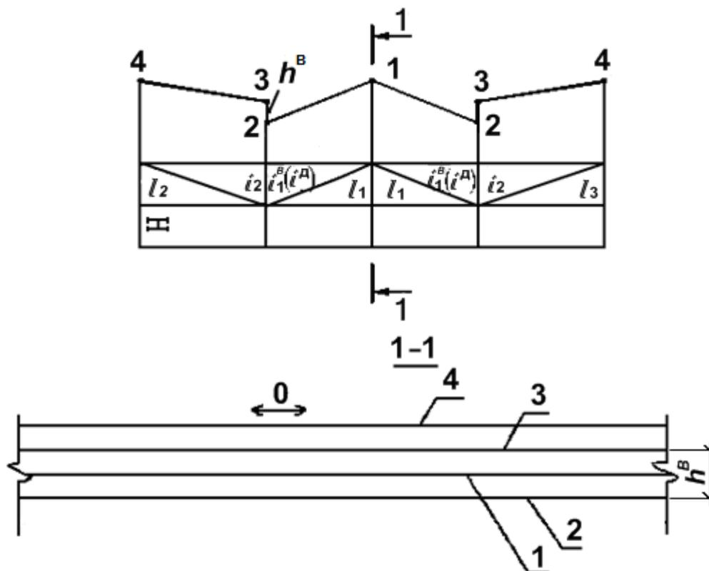
Рис. 10.1. Исходные поперечный и продольный профили улицы
