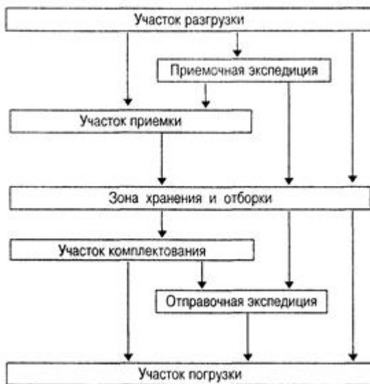
Рис. 1.2. Принципиальная схема материального потока на складе предприятия оптовой торговли
