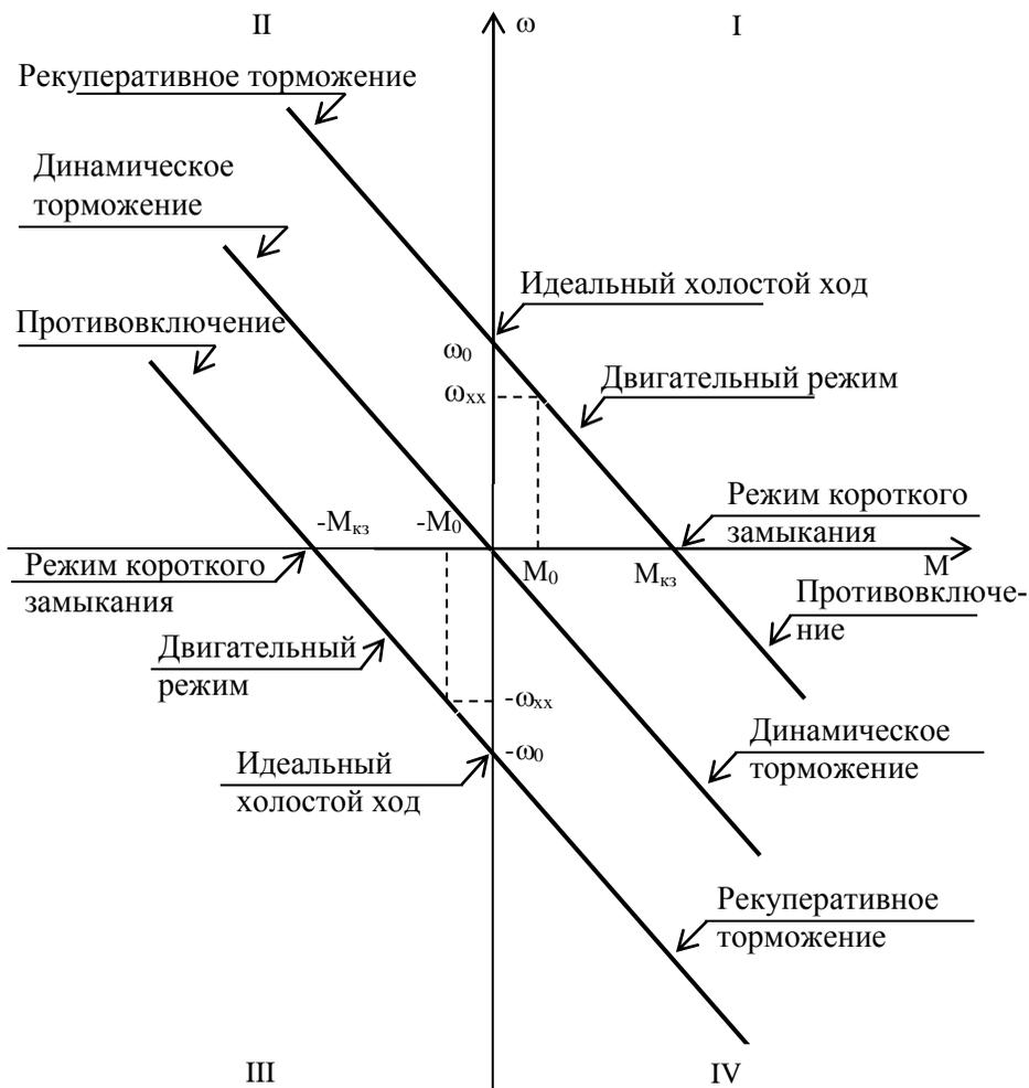
Рис. 2.3. Механические характеристики ДПТ
