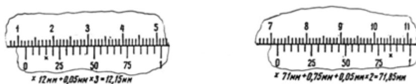
Рис. 2.5. Чтение показаний на штангенциркуле с величиной отсчета 0,05 мм
