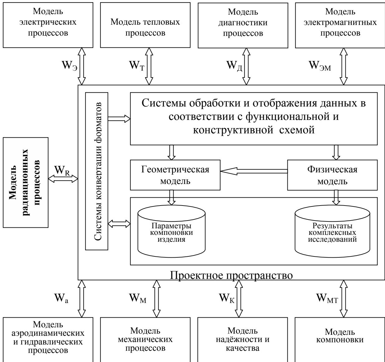
Рис. 2.1. Системная комплексная модель сложной радиоэлектронной системы
