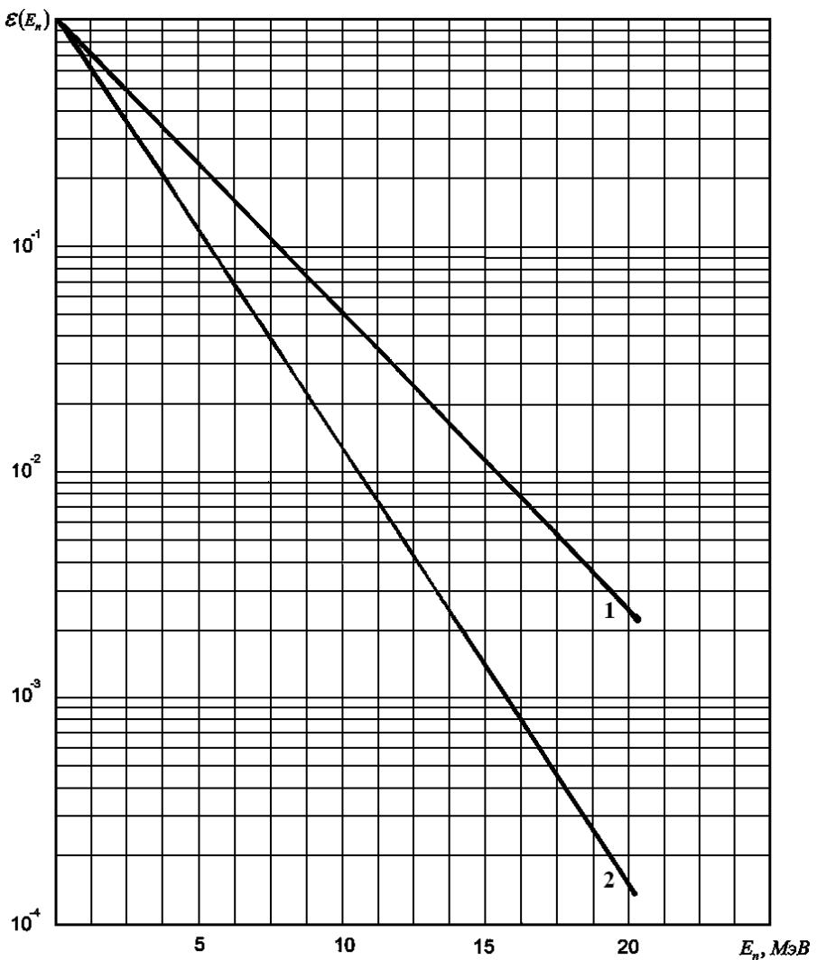
Рис. 2.6. Интегральный спектр энерговыделения в объёме  $V_{\phi} = 10^x 10^x 10 \text{мкм}$  от  $(p, Si)$  ядерных реакций протонов 1 - 1000 МэВ и 2 – 150 МэВ
