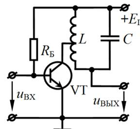
**Задание 0301.** Крутизна  $S$  проходной вольтамперной характеристики транзистора, на котором построен линейный усилитель, равна 10 мА/В. Эквивалентное резонансное сопротивление нагрузочного колебательного контура –  $R_{\text{КЭ}} = 15$  кОм. Коэффициент усиления на резонансной частоте такого усилителя составляет ....
