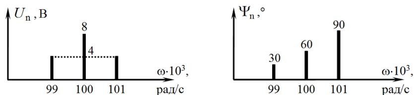
**Задание 0206.** На идеальный частотный модулятор с крутизной  $k_{\text{ЧМ}} = 8000$  рад/(В·с) поступает высокочастотное колебание  $s_{\text{Н}}(t) = 4 \cdot \cos(2 \cdot 10^6 \cdot t)$  (В) и информационный сигнал, показанный на рисунке. Девияция частоты колебания на выходе модулятора составляет ... рад/с.
