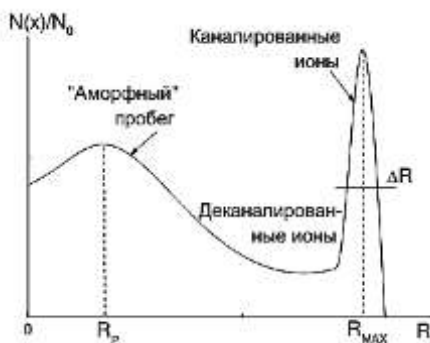
Рис. 7.2. Распределения внедренных атомов при эффекте каналирования
