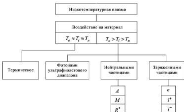
Рис. 1.2. Типы воздействия плазмы на обрабатываемый материал
