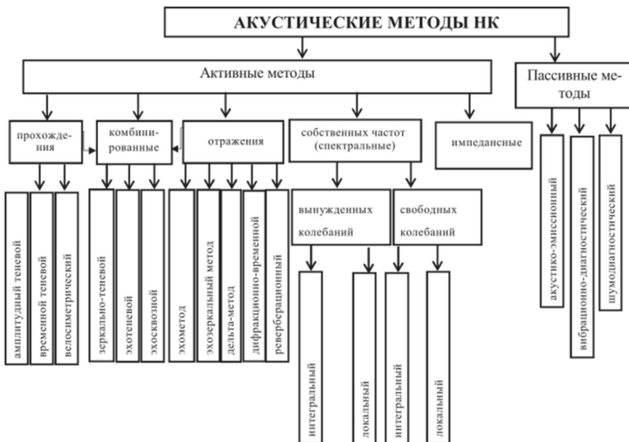
Рис. 11. Классификация акустических методов контроля и диагностики по ГОСТ 23829-79
