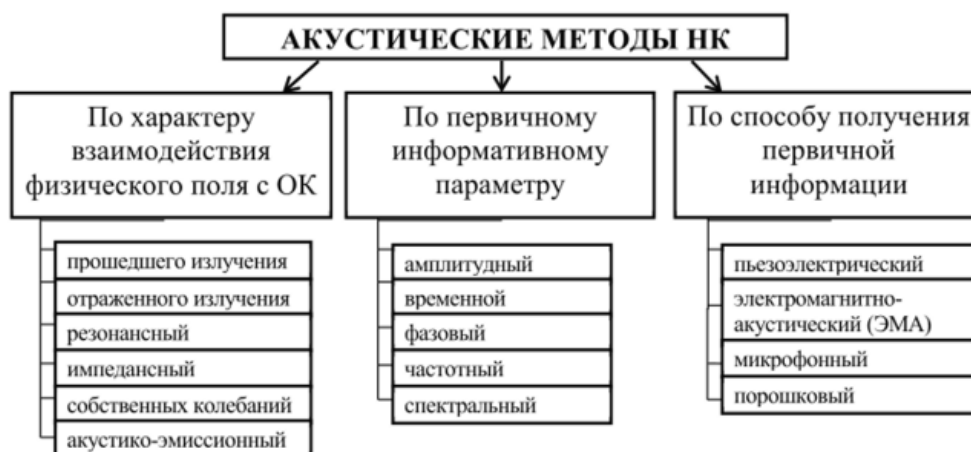
Рис. 10. Классификация акустических методов контроля по ГОСТ 18353-79
