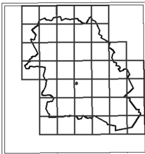
Аналогичным образом строим контуры минутной и внешней рамок через 1 миллиметр в масштабе чертежа (200 м).
