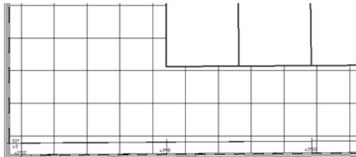
Полученная километровая сетка подписывается двумя цифрами, высотой шрифта 3 мм (600м).
