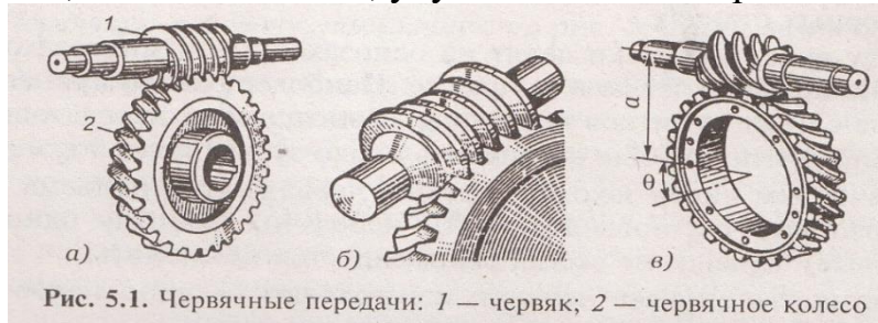
Рис. 9.1. Червячные передачи: 1 – червяк, 2 – червячное колесо
