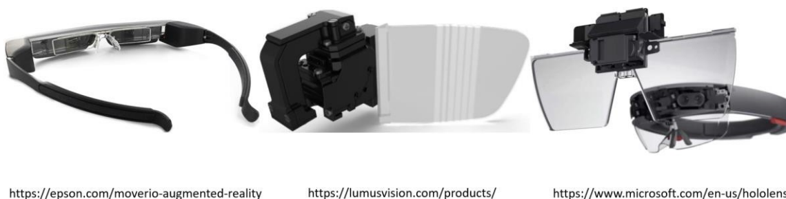
Рис. 7. Оптические системы дополненной реальности, построенные на принципе передачи изображения по свето- и волноводным каналам
