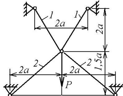
9. Стержень, изображенный на схеме, закреплен при  $t = -10^{\circ}\text{C}$ . Определить напряжения при нагреве стержня на  $100^{\circ}\text{C}$  при  $a = 0,2\text{ м}$ . Модули упругости меди и стали равны  $E_1 = 1.1 \cdot 10^5\text{ МПа}$ ,  $E_2 = 2 \cdot 10^5\text{ МПа}$ ,  $F = 2\text{ см}^2$ . Для стали коэффициент температурного расширения равен  $1.25 \cdot 10^{-5}\text{ 1/град}$ , для меди  $-2.5 \cdot 10^{-5}\text{ 1/град}$ .
