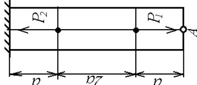
8. Определить допускаемую нагрузку  $P$  на систему симметричную систему стержней, если  $E_1 = 2*10^5$  МПа,  $F_1 = 10$  см $^2$ ,  $E_2 = 10^5$  МПа,  $F_2 = 20$  см $^2$ ,  $[\sigma]_1 = 160$  МПа,  $[\sigma]_2 = 60$  МПа.
