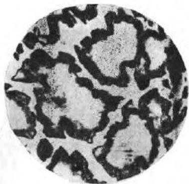
**Рис. 8.** Микроструктура литой бронзы с 16 % Sn, x400:
