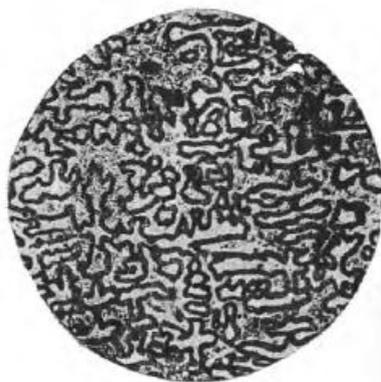
**Рис. 7.** Микроструктура литой бронзы с 10 % Sn, x200:
