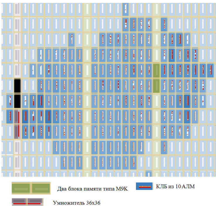
Рис. 1.31. Размещение проекта микропроцессорного ядра or1200 в ПЛИС Altera Stratix III EP3SL340F1760C2
