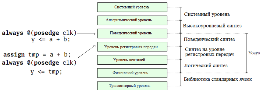
Рис. 2.1. Уровни абстракции и синтеза при проектировании цифровых БИС, а также область использования программного инструмента Yosys (три уровня синтеза)
