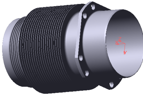
Рис. 1.2. Общий вид гильзы цилиндра поршневого звездообразного авиационного двигателя
