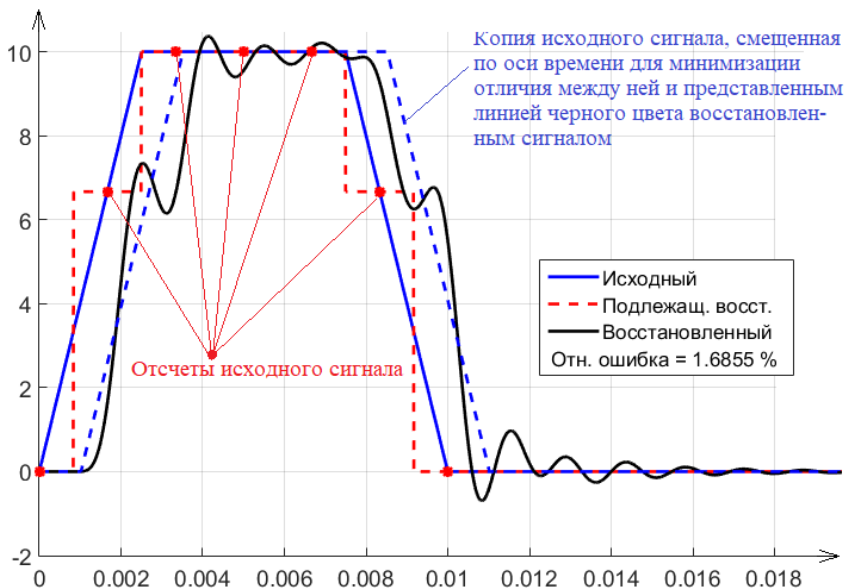
Рис. 3.4. Пример восстановления сигнала трапецевидной формы по его дискретным отсчетам
