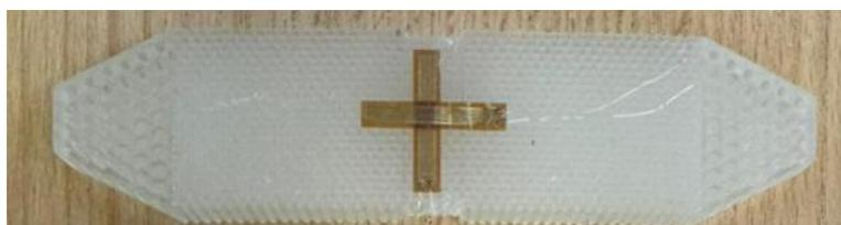
Образцы для испытания на растяжение
