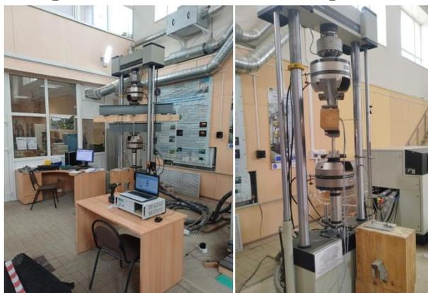
В работе впервые изучены свойства соединения углеродной ленты с деревянным мостовым брусом, а также доказано что применение углеродной ленты в качестве арматуры значительно превышает прочность деревянного мостового бруса как при статических нагрузках, так и при динамических.
