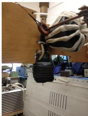
Индуктор с сердечником, закрепленный на сварочной горелке
