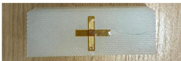
Образцы для испытания на сжатие
