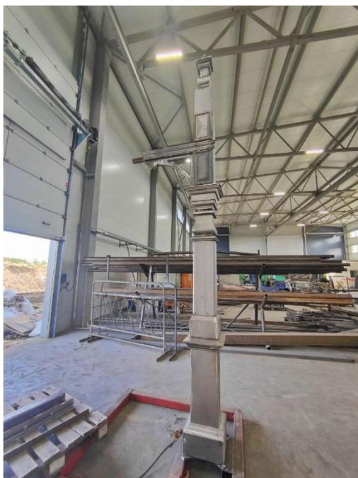
**Композитный изгибаемый элемент таврового сечения**
