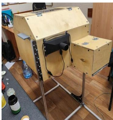
Напольное исполнение комплексного многофункционального корпуса лазерного гравера
