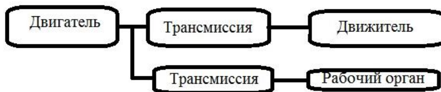
Рис. 1.11. Базовая структура самоходной строительной машины
