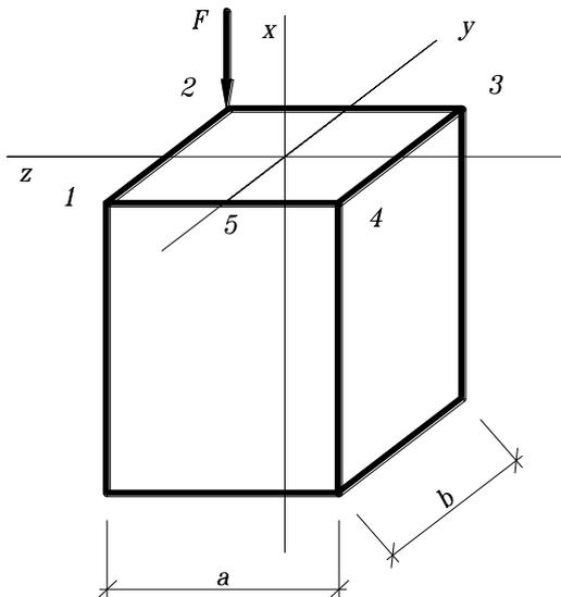
22. Определить напряжение в т. 2, если
