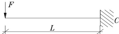
30. Определить вертикальную реакции в заделке С.
