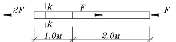
6. Определить напряжения в сечении  $k-k$  стержня, если
