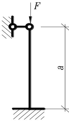
25. Какой коэффициент приведения длины следует принять в формуле Эйлера для данной схемы закрепления стержня:
