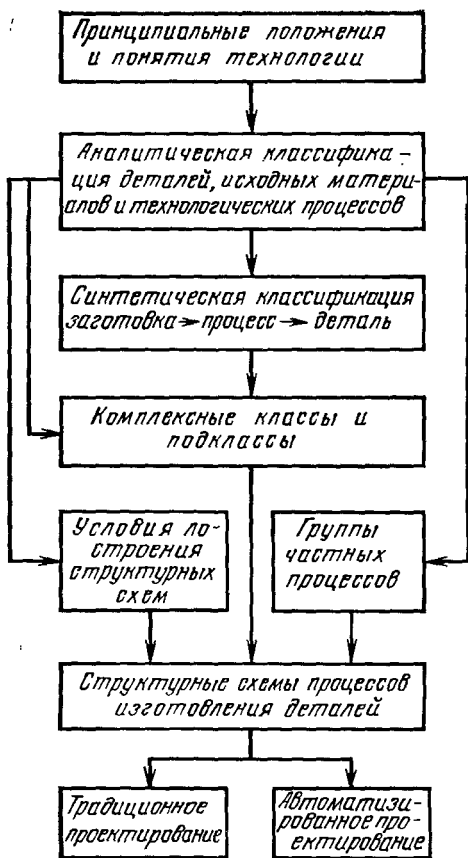
Рис. 11.1. Схема разработки комплексного метода проектирования процессов изготовления детали
