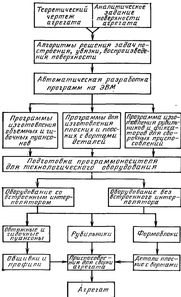
Рис. 2.21. Укрупненная схема изготовления агрегата при независимом методе увязки с использованием ЭВМ и оборудования с числовым программным управлением
