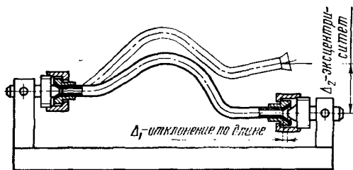
Рис. 20.9. Вид отклонения трубки от номинальных размеров
