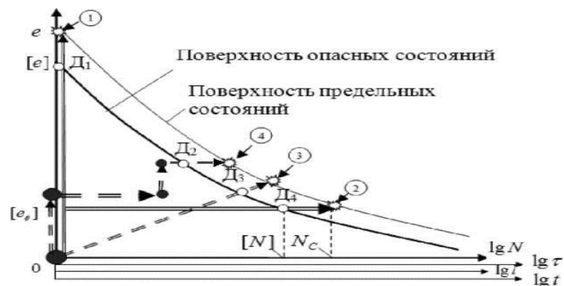
Рис. 3. Механизмы достижения опасных и предельных состояний по деформационным критериям при однократном воздействии и N циклах нагружения
