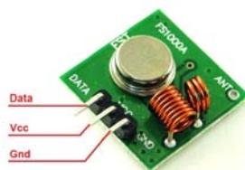
Рис. 1.10.1. Внешний вид и назначения выводов передатчика FS1000A [15]
