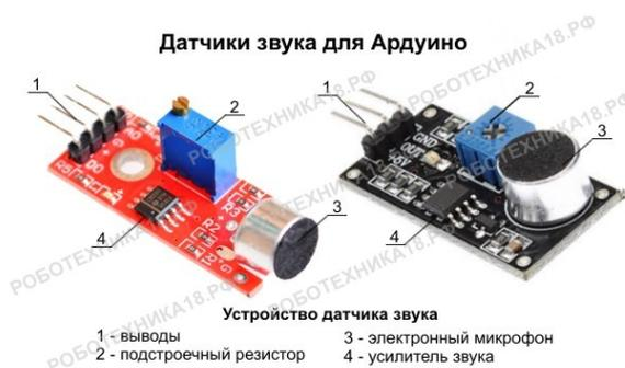
Рис. 2.7.1. Датчик звука Arduino для слежения за уровнем шума и обнаружения громких сигналов [20]
