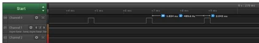
Рис. 2.1.7. Внешний вид сигнала ШИМ
