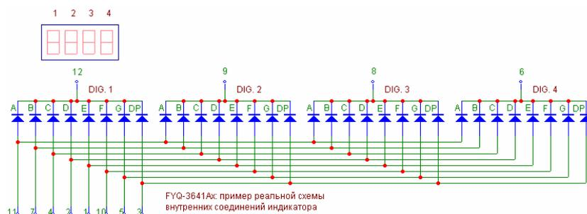
Рис. 1.4.5. Схема индикатора FYQ-3641AX [6]
