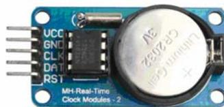
Рис. 1.3.1. Внешний вид модуля часов реального времени DS1302 [5]
