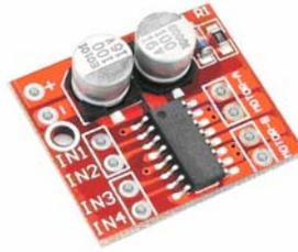
Рис. 2.9.5. Внешний вид модуля Н моста на микросхеме MX1508 [15]
