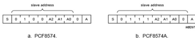
Рис. 1.7.2. Образование адреса микросхемы PCF8574 [12]
