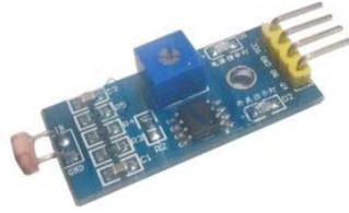
Рис. 2.8.3. Внешний вид модуля фоторезистора [15]
