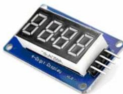
**Рис. 2.10.1.** Внешний вид модуля семисегментных индикаторов на базе драйвера TM1637 [21]
