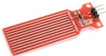
**Рис. 1.11.1.** Внешний вид датчика уровня воды [16]
