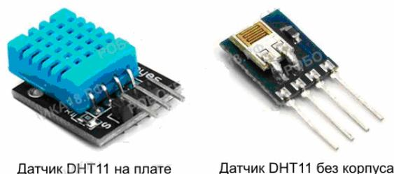
Датчик DHT11 на плате
