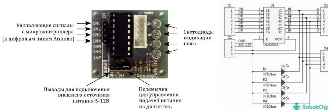
Рис. 2.12.7. Внешний вид модуля со схемой назначения выводов и принципиальной схемой [15]
