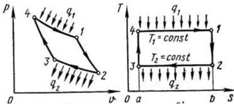
Покажите на диаграммах работу цикла  $A_{ц}$ ,  $T_1$ ,  $T_2$ , количество подведённого и отведённого тепла  $q_1$  и  $q_2$ . КПД цикла.
