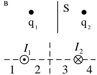
8. Два бесконечно длинных прямолинейных проводника с противоположными токами ( $I_2=2I_1$ ) лежат в плоскости, перпендикулярной плоскости рисунка. На каком участке находятся точки, в которых магнитная индукция равна нулю?
