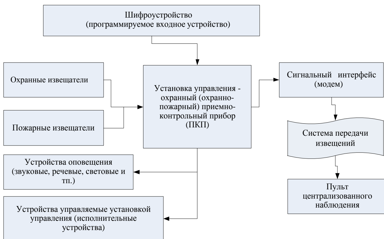
Рис. 3. Общая структура автоматической пожарной сигнализации
