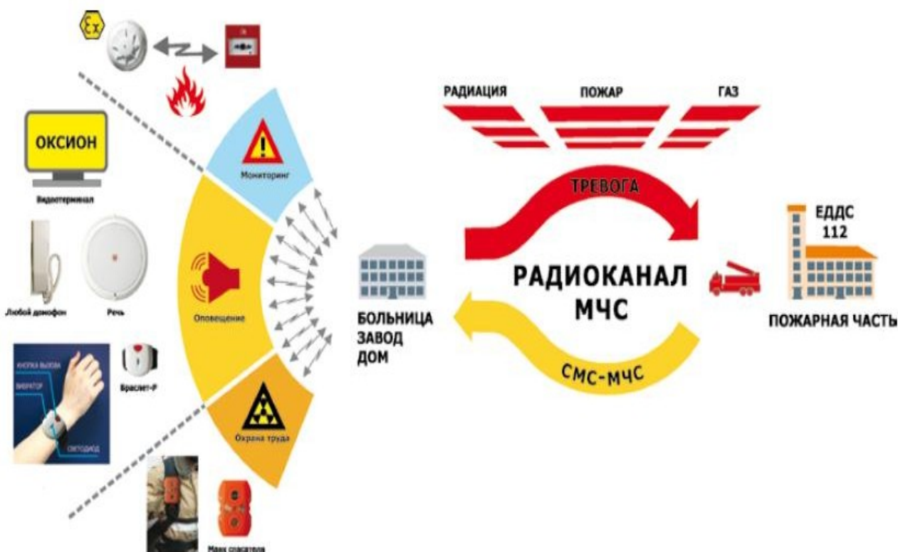
Рис. 42. Структурная схема комплекса «Радиоволна»
