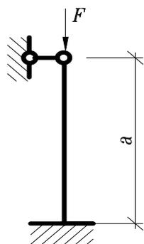
14. Какой коэффициент приведения длины следует принять в формуле Эйлера для данной схемы закрепления стержня:
