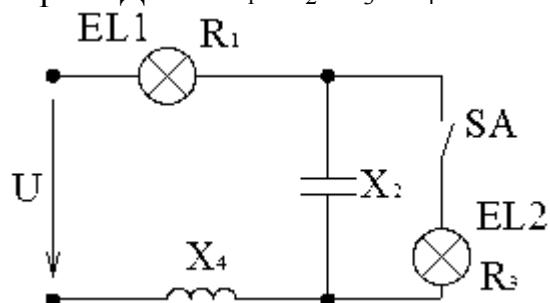
**6.** Рассчитать линейные и фазные токи и напряжения приемников. Построить топографические диаграммы, совмещенные с векторными диаграммами токов. Данные для расчета:  $U_\text{л}=220$  В;  $R=X=100$  Ом.
