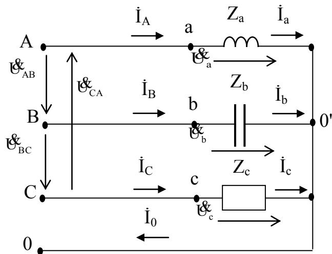
8. В трехфазную электрическую сеть с линейным напряжением 380 В включен трехфазный приемник. Дано: мощность фаз приемника:  $S_a=5,2\text{ кВА}$ ;  $Q_b=4,5\text{ кВАр}$ ;  $P_c=2,6\text{ кВт}$ ;  $\varphi_a=\varphi_b=\varphi_c=-60^\circ$ . Изобразите схему замещения цепи. Определите все мощности трехфазного приемника, фазные токи и сопротивления фаз. Постройте векторную диаграмму.
