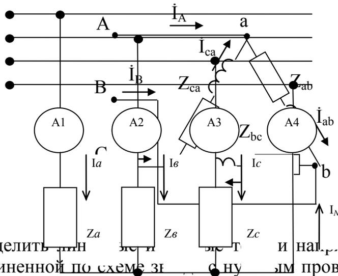
7. Определить фазные и линейные токи и напряжения в трехфазной нагрузке, соединенной по схеме ЗТ к нулю одним проводом, сопротивление которого равно нулю. Питание осуществляется от источника с линейным напряжением  $U_{л}=220\text{В}$ , сопротивления фаз нагрузки:  $Z_a=jX_L=j100\ \text{Ом}$ ,  $Z_b=-jX_C=-j100\ \text{Ом}$ ,  $Z_c=R=100\ \text{Ом}$ . Построить топографическую диаграмму, совмещенную с векторной диаграммой токов.
