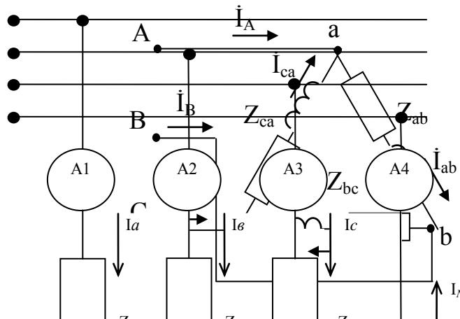
7. Определить и нарисовать векторные диаграммы токов в трехфазной нагрузке, соединенной по схеме звезду с общим проводом, сопротивление которого равно нулю. Питание осуществляется от источника с линейным напряжением  $U_L=220\text{ В}$ , сопротивления фаз нагрузки:  $Z_a=jX_L=j100\text{ Ом}$ ,  $Z_b=-jX_c=-j100\text{ Ом}$ ,  $Z_c=R=100\text{ Ом}$ . Построить топографическую диаграмму, совмещенную с векторной диаграммой токов.
