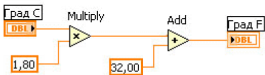
Рис.4. Блок-диаграмма ВП «Преобразование температуры»
