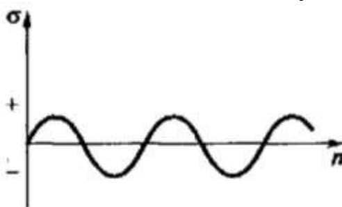
Рис. 1.10. Изменение напряжений в образце в зависимости от знакопеременной нагрузки в течение n циклов
