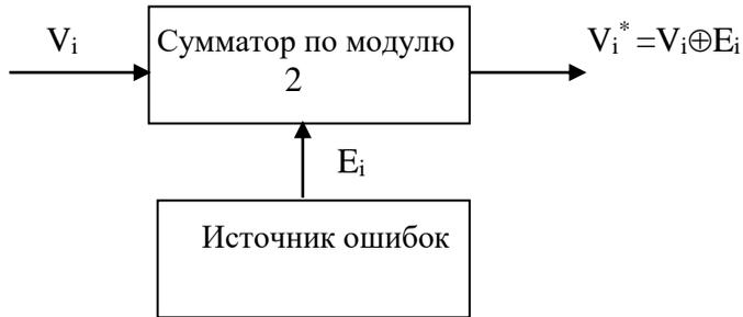
Рис. 1.3. Эквивалентная схема двоичного симметричного канала
