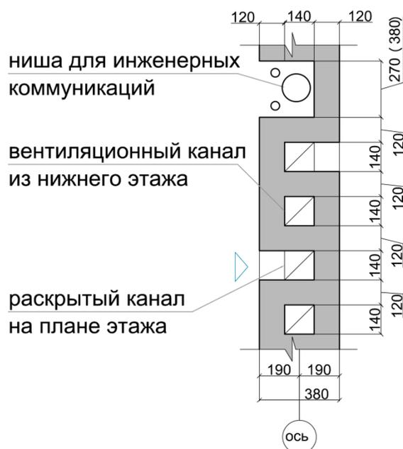
Фрагмент стены из кирпича с вентканалами в два ряда
