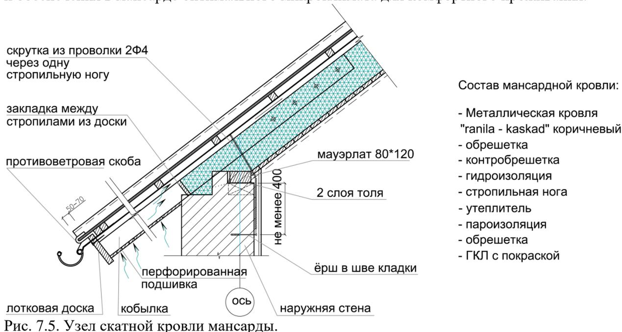
Рис. 7.5. Узел скатной кровли мансарды.
