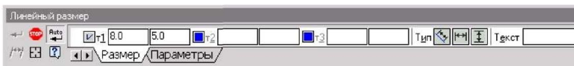
Рис. 2.7 - Вид **Панели свойств** при нанесении линейных размеров
