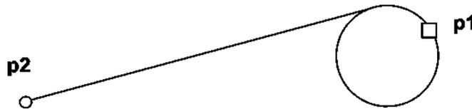
Рис. 1.11. - Построение отрезка, касательного к окружности
