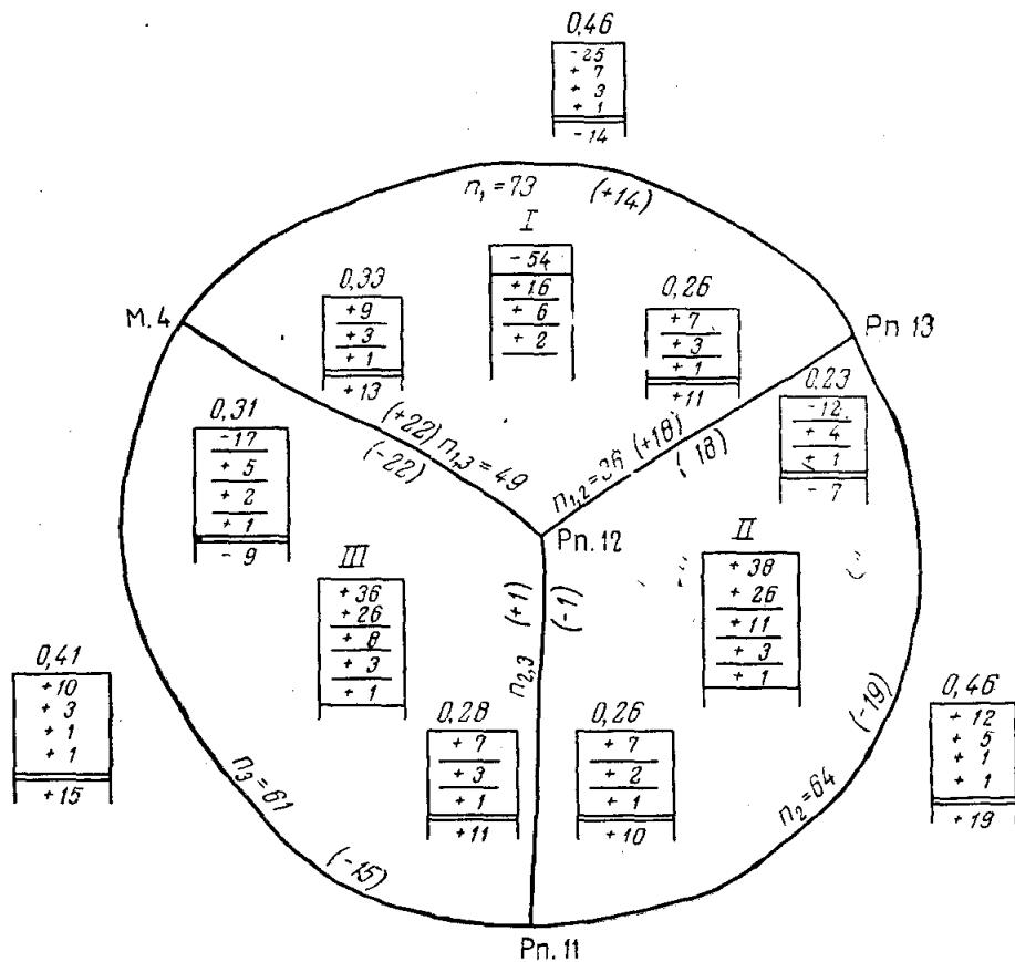
Рисунок 7.7 – Новая схема для вычисления поправок в звенья
