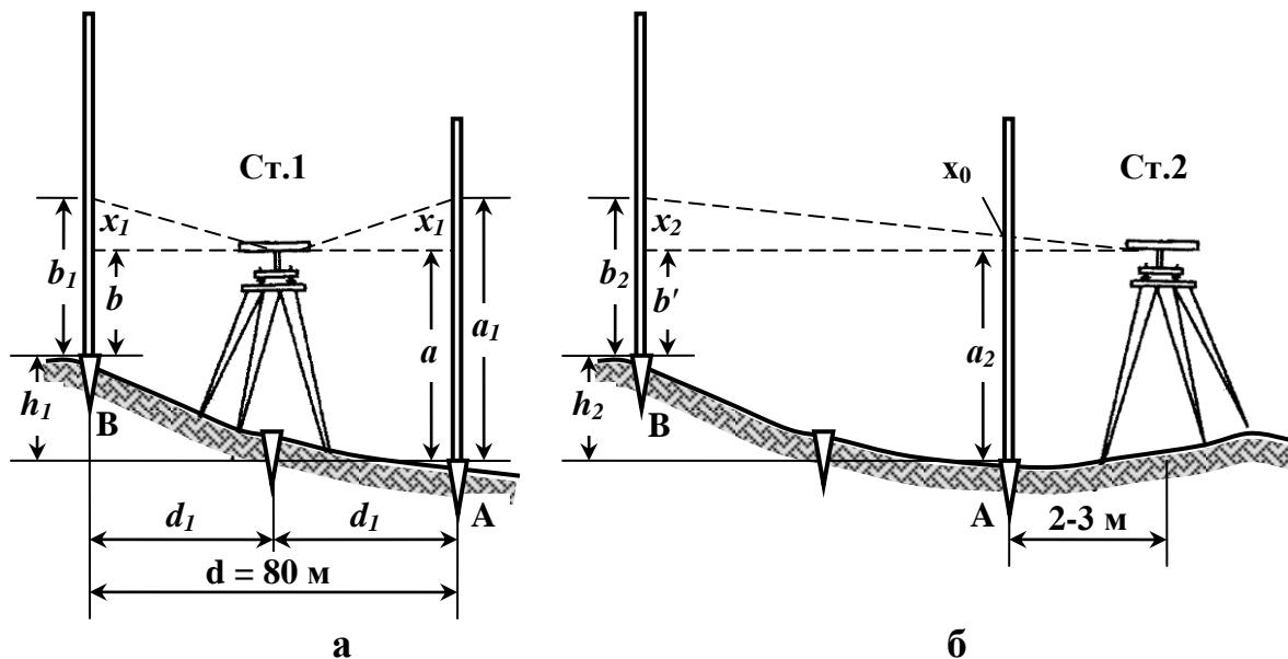
Рисунок 3.10 – Схема поверки главного условия нивелиров по способу из середины и вперед
