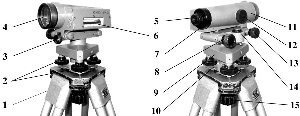
1 - штатив; 2 - подъемные винты; 3 - закрепительный винт; 4 - объектив; 5 - окуляр; 6 - цилиндрический уровень; 7 - предохранительный колпачок; 8 - элевационный винт; 9 - подставка; 10 – пружинящая пластина; 11 - зрительная труба; 12 - кремальера; 13 - наводящий винт; 14 - круглый уровень; 15 - станововой винт
