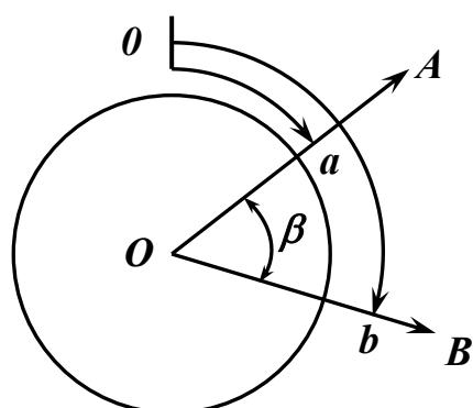
Рисунок 2.2 – Измерение горизонтальных углов способом приемов
