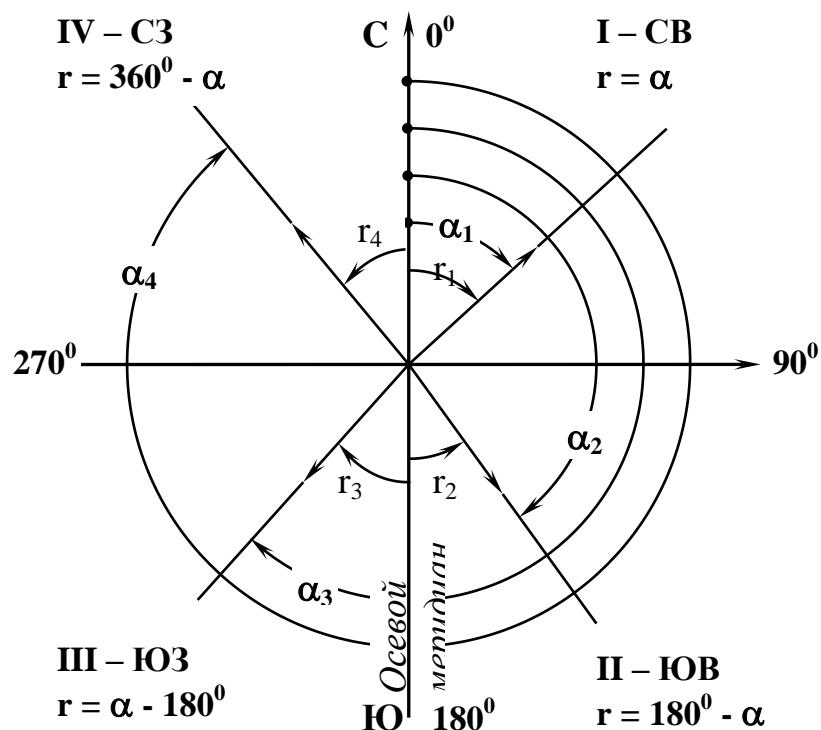
Рисунок 4.1 – Связь между дирекционными углами и румбами
