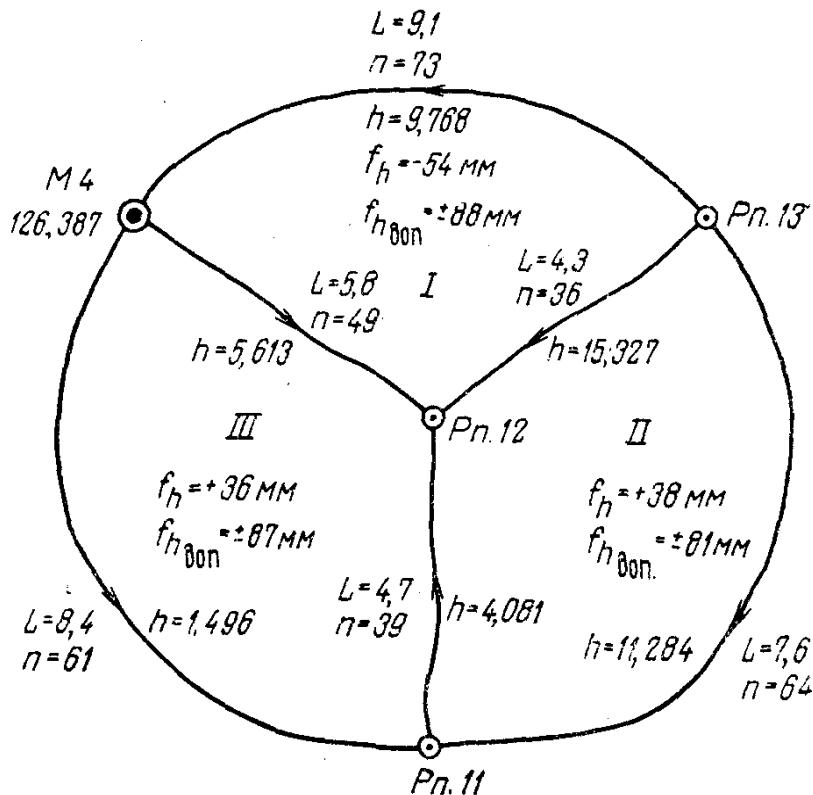
Рисунок 7.6 – Схема уравновешивания нивелирной сети полигонов
