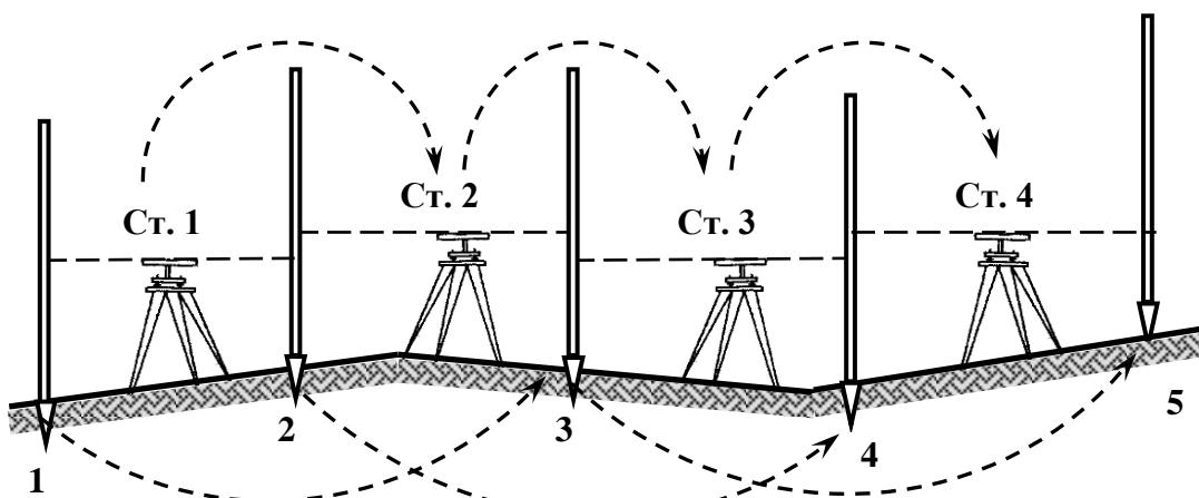
Рисунок 5.1 – Нивелирный ход при привязке точки
