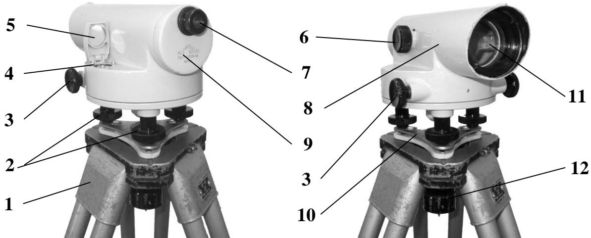
1 - штатив; 2 - подъемные винты; 3 – бесконечный наводящий винт; 4 – круглый уровень; 5 – зеркальце круглого уровня; 6 - кремальера; 7 - окуляр; 8 – зрительная труба; 9 – предохранительный колпачок; 10 – пружинящая пластина; 11 - объектив; 12 - станиновой винт
