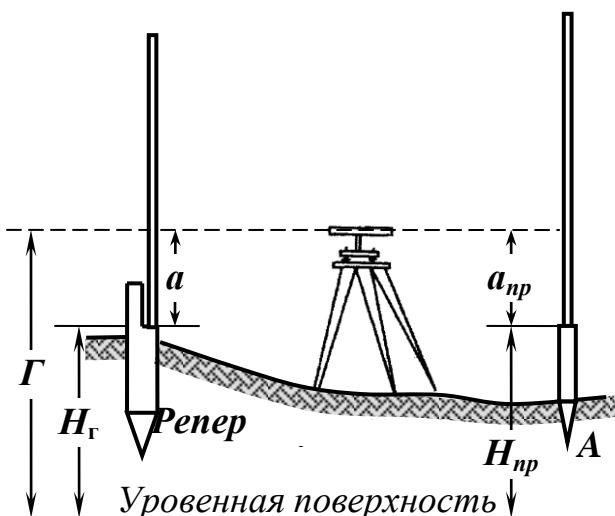
Рисунок 9.5 – Вынос в натуру проектной отметки
