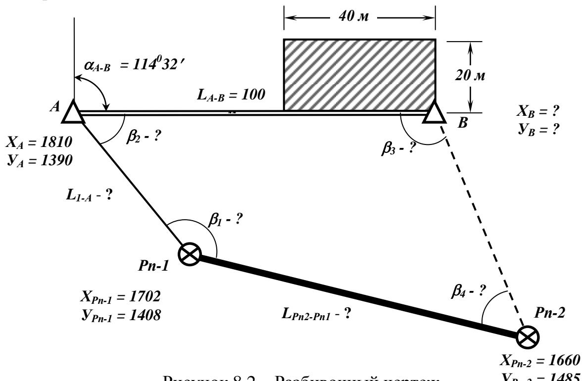
Рисунок 8.2 – Разбивочный чертеж
