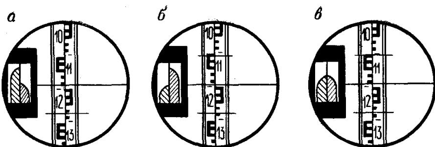
а, б – при положении пузырька цилиндрического уровня вне нуль-пункта,
