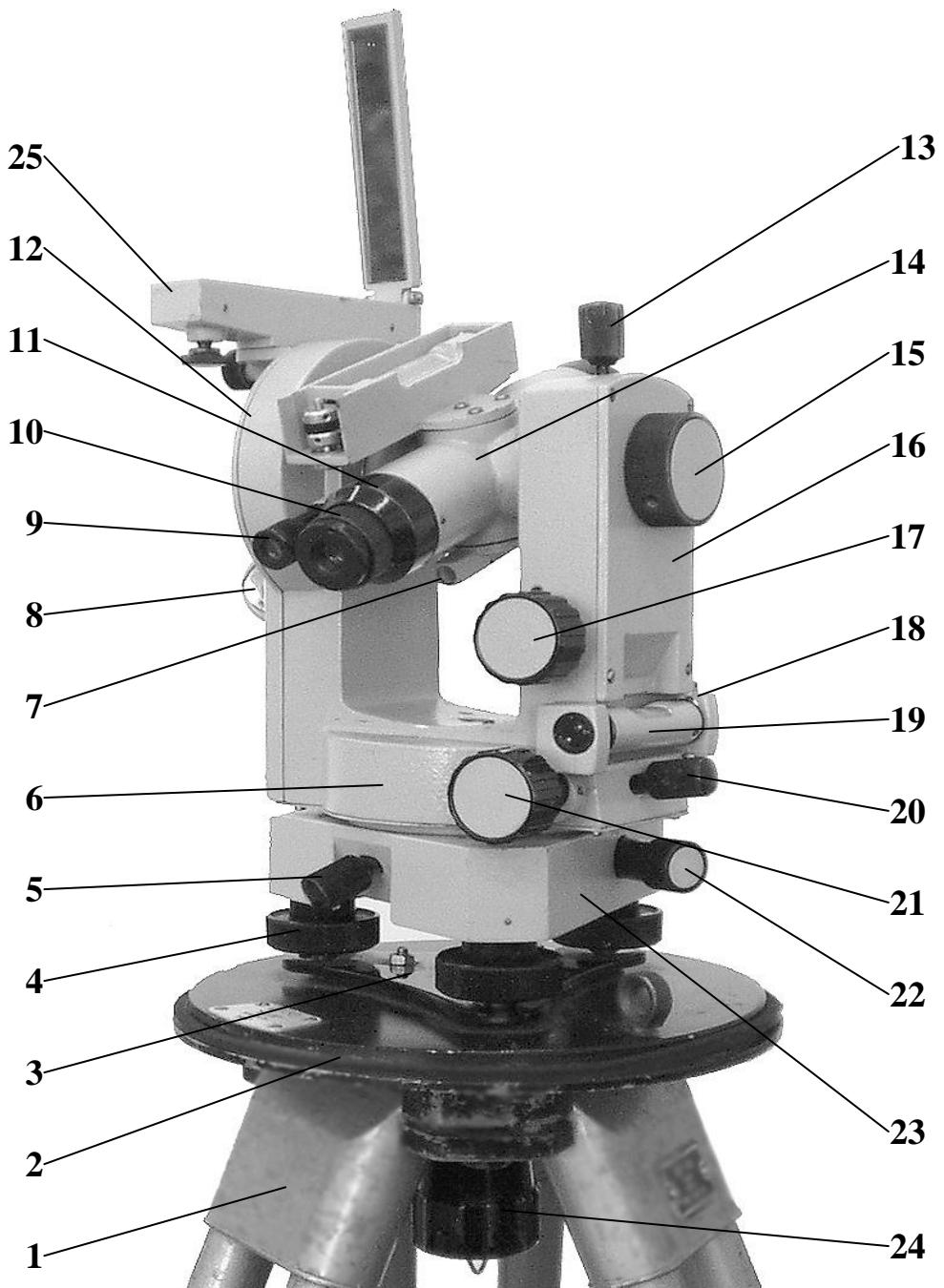
1 - штатив; 2 – основание теодолита; 3 – трегерная пластина; 4 – подъемные винты;
