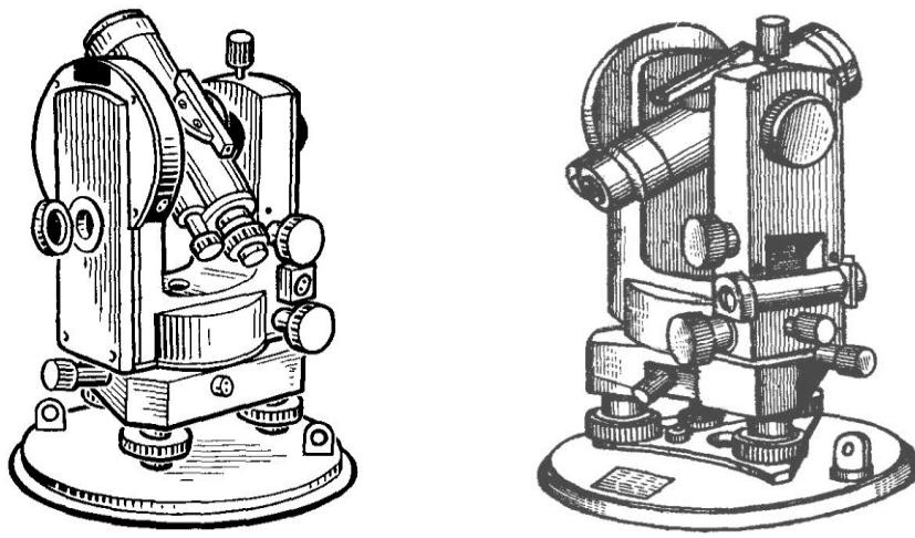
Рис. 1.1. Общий вид теодолита 2Т-30
