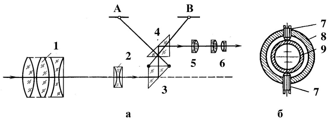
1 – объектив; 2 – фокусирующая линза; 3, 4 – призмы компенсатора; 5 – сетка нитей; 6 – окуляр; 7 – юстировочные винты; 8 – оправа окуляра; 9 – диафрагма сетки нитей
