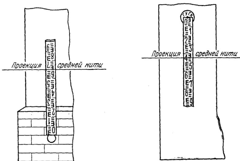
а – к стенному реперу; б – к стенной марке
