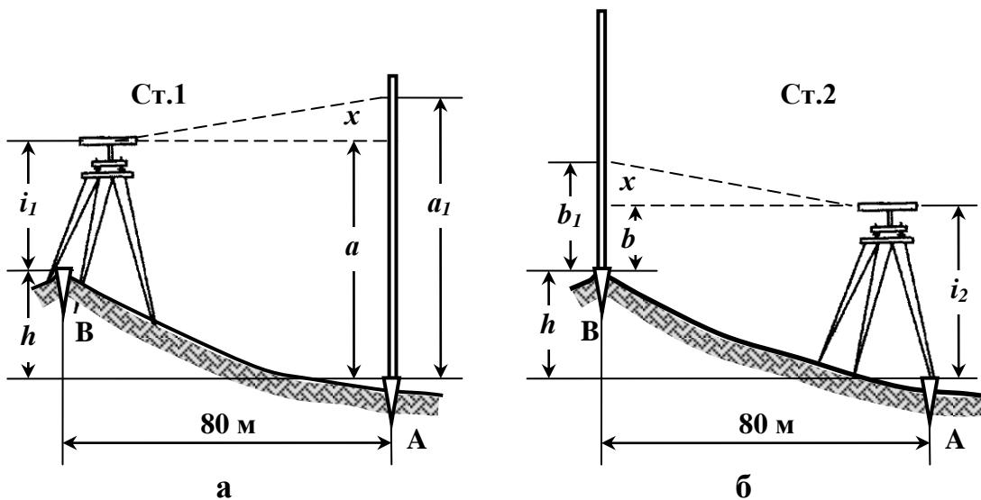
Рисунок 3.9 – Схема поверки главного условия нивелиров по способу вперед
