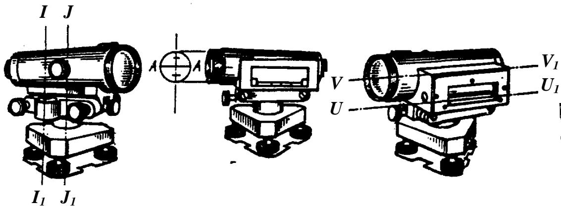
$I_1$  – ось круглого (установочного) уровня,  $JJ_1$  – ось вращения прибора,  $VV_1$  – визирная ось,  $UU_1$  – ось цилиндрического уровня
