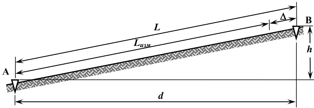
Рисунок 9.2 – Построение линий заданной длины способом редукции
