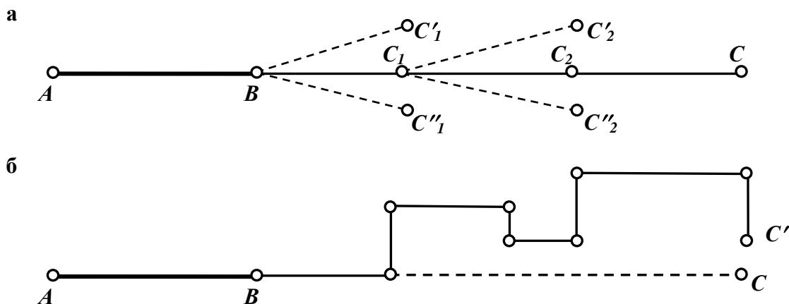
а – способом вешения; б – проложением теодолитного хода
