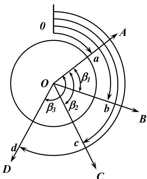
Рисунок 2.3 – Измерение горизонтальных углов способом круговых приемов
