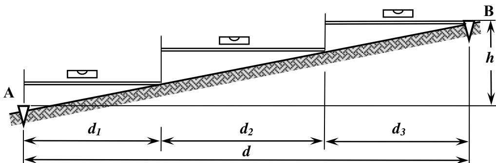
Рисунок 9.1 – Построение линий заданной длины способом ватерпасовки
