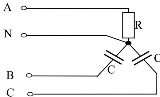
6. Линейное напряжение трехфазного трансформатора, соединенного звездой с нулевым проводом, равно 220 В. В фазе А включено 30 одинаковых ламп 40 Вт, 127 В каждая, в фазе В – 20 ламп, а фаза С – 10 ламп. Определить ток в нейтрали и напряжение на каждой группе ламп при обрыве нулевого провода.
