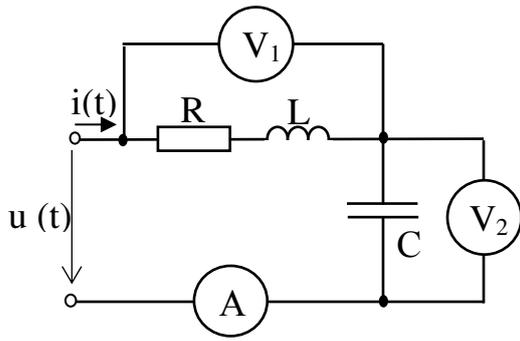
8. Определить показания приборов электромагнитной системы в цепи, схема которой показана на рисунке, записать выражение мгновенного значения тока, если:  $R=50\text{ Ом}$ ,  $\omega L=10\text{ Ом}$ ,  $\frac{1}{\omega C}=90\text{ Ом}$ . На вход цепи подано несинусоидальное напряжение, заданное в виде аналитического разложения в ряд Фурье  $u(t)=100+310\sin(\omega t+30^\circ)+106\sin(3\omega t-30^\circ)\text{ В}$ .
