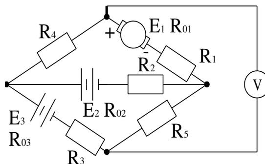
2. Запишите уравнение энергетического баланса для цепи. Определите мощности, отдаваемые источником  $E_3$  и потребляемые приемниками  $E_2$  и  $R_5$ .
