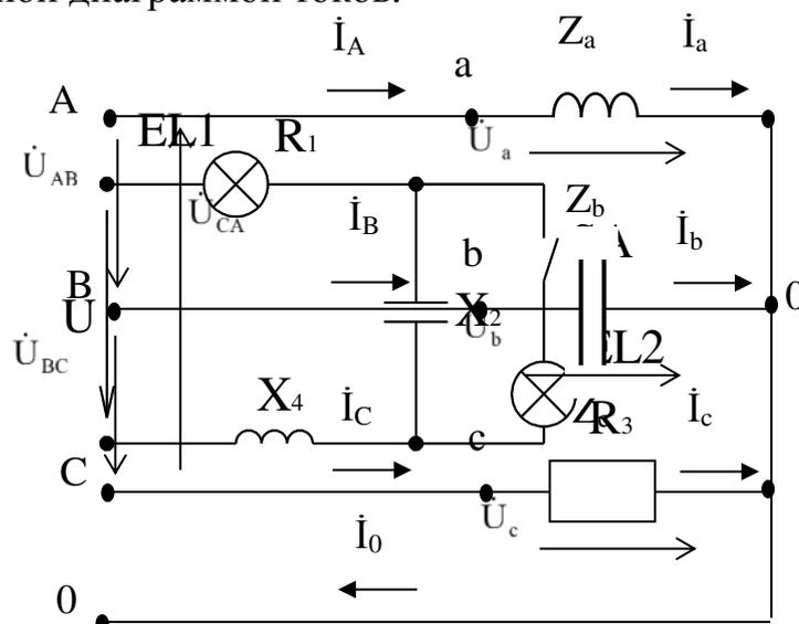
8. В трехфазную электрическую сеть с линейным напряжением 380 В включен трехфазный приемник. Дано: мощность фаз приемника:  $S_a=5,2$  кВА;  $Q_b=4,5$  кВАр;  $P_c=2,6$  кВт;  $\varphi_a=\varphi_b=\varphi_c=-60^\circ$ . Изобразите схему замещения цепи. Определите все мощности трехфазного приемника, фазные токи и сопротивления фаз. Постройте векторную диаграмму.
