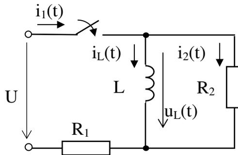
10. Катушка, индуктивность которой равна  $0,12\text{ Гн}$  и сопротивление  $1\text{ Ом}$ , включается на постоянное напряжение  $30\text{ В}$ . Чему равна постоянная времени этой катушки? С какой скоростью нарастает ток в начальный момент? Чему равно установившееся значение тока?
