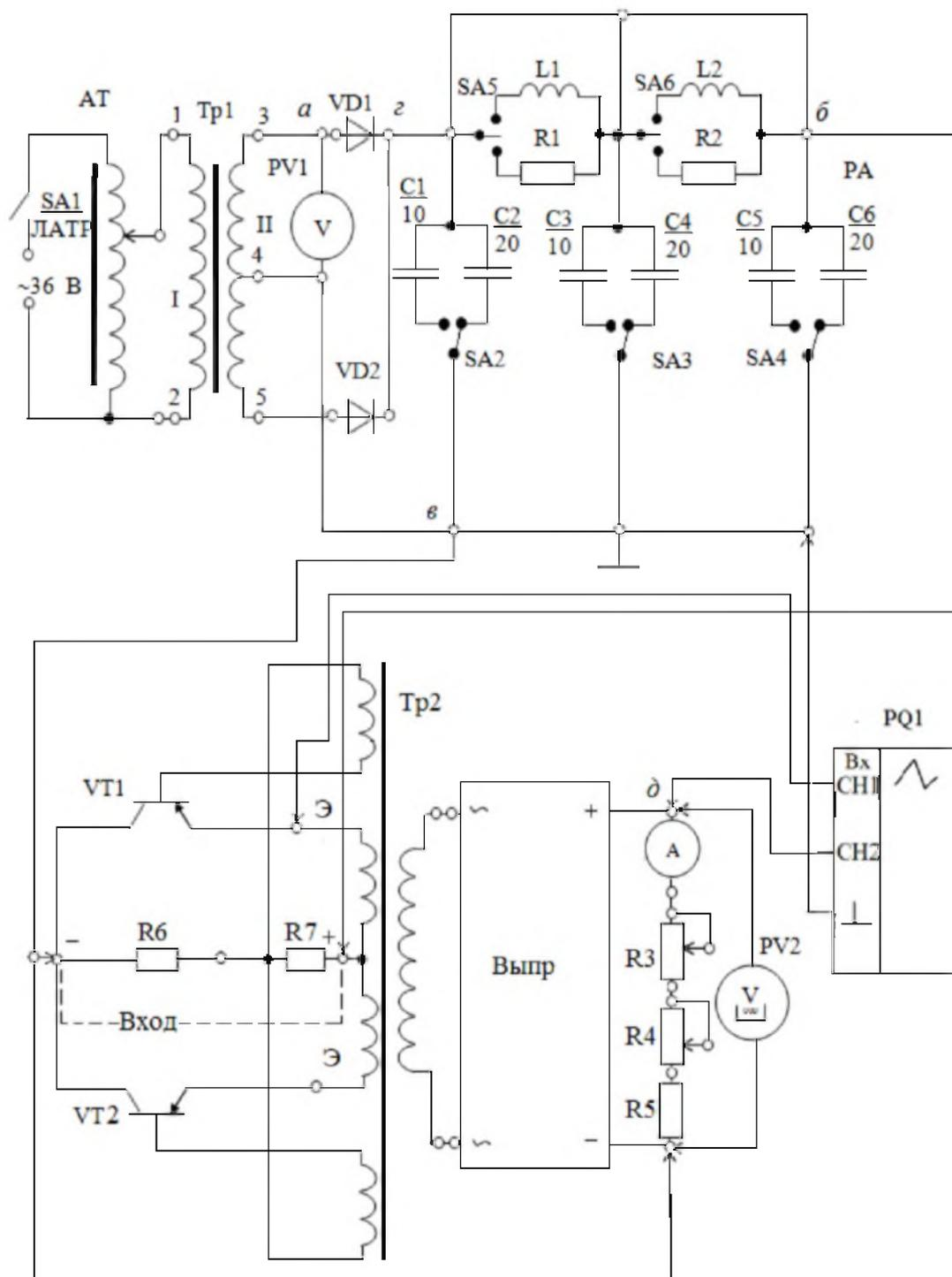
Схема лабораторной установки для проведения измерений параметров
