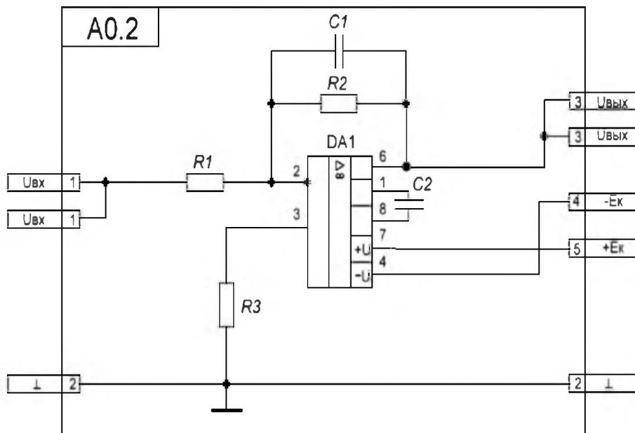
а) Схема электрическая принципиальная активного фильтра нижних частот первого порядка на основе интегрирующей RC-цепочки, включенной на входе ОУ
