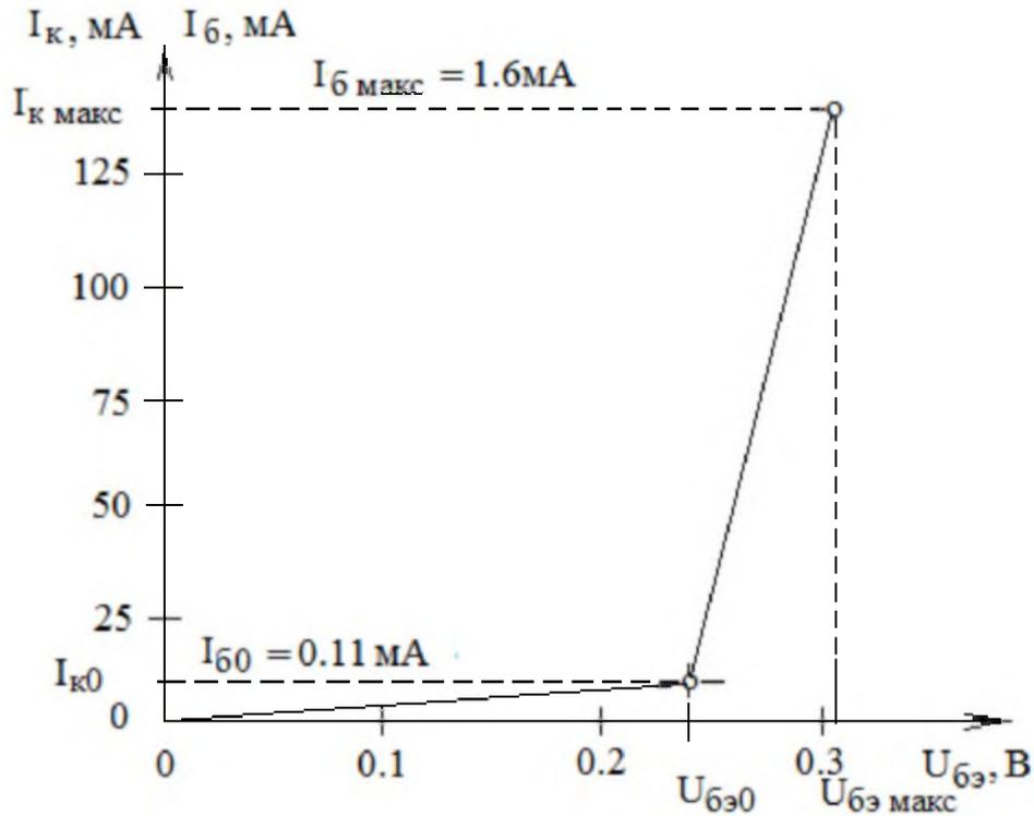
а) Линейно-кусочная аннроксимация входной и проходной ВАХ транзистора КТ503Б, включенного по схеме с ОЭ
