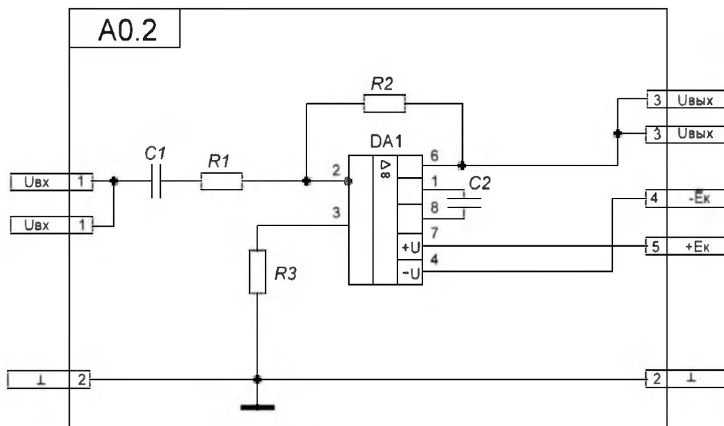
а) Схема электрическая принципиальная активного фильтра нижних частот первого порядка на основе интегрирующей RC-цепочки, включенной на входе ОУ
