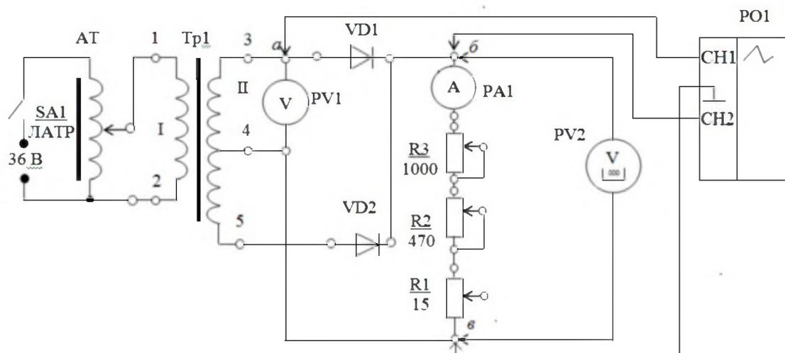
Схема лабораторной установки для проведения исследований
