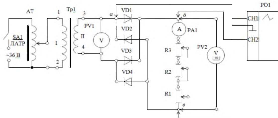
Схема лабораторной установки для проведения исследований
