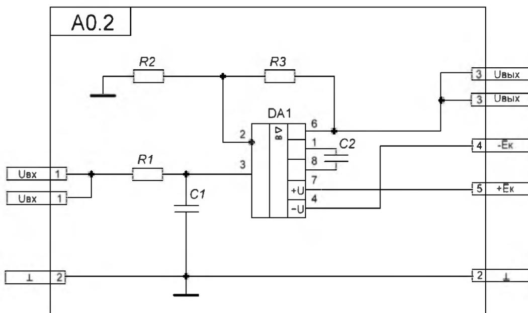
**а) Схема электрическая принципиальная активного фильтра нижних частот первого порядка на основе интегрирующей RC-цепочки, включенной на входе ОУ**
