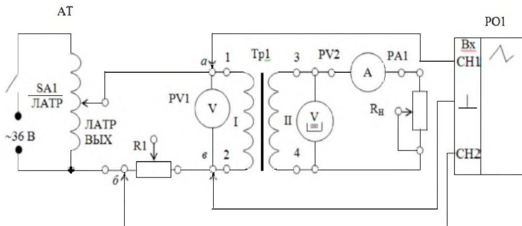
Схема лабораторной установки для проведения исследований силового трансформатора в режиме
