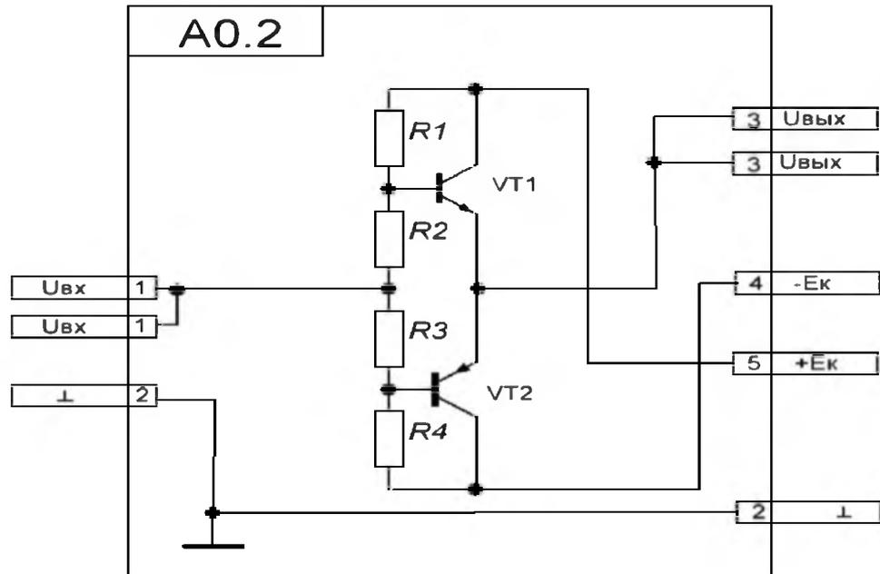
а) Схема электрическая принципиальная оконечного каскада УМ при работе транзисторов в режиме В
