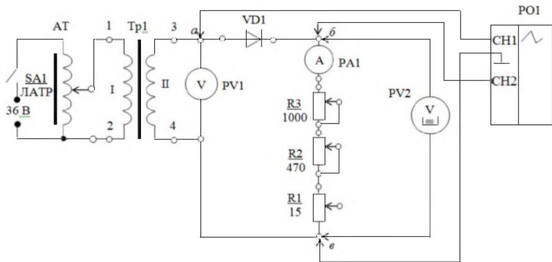
Схема лабораторной установки для проведения исследований
