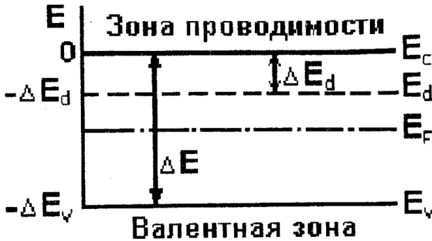
Рис. 2.2. Собственные и примесные переходы плотность квантовых состояний
