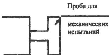
**Остатки питателей, выпоров, промывников, стяжек и прибылей** изображают на чертеже отливки. Линия отрезки должна соответствовать способу отрезки: при удалении резцом, дисковой фрезой, пилой и т.д. ее обозначают сплошной тонкой линией, при огневой резке или обламывании - сплошной волнистой линией.
