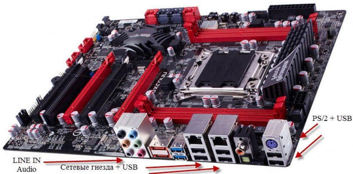
Она регулирует частоты работы процессора и планок оперативной памяти. Регулирует скорость вращения кулеров, скорость передачи данных между жесткими дисками. Распределяет подачу тока между внутренними компонентами. Проверяет работоспособность всех подключенных к ней компонентов при включении компьютера с помощью BIOS.
