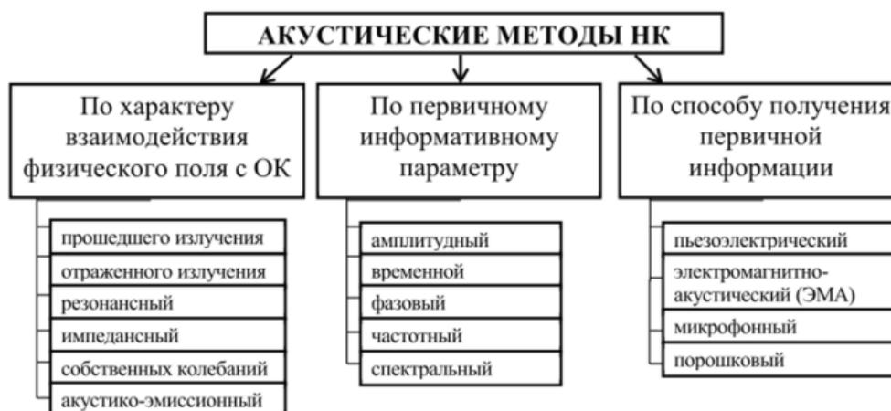
Рис. 10. Классификация акустических методов контроля по ГОСТ 18353-79
