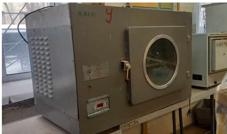
Рис. 3. Сушильный шкаф для изучения влияния теплового старения на свойства полимербетона
