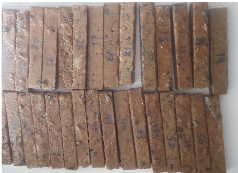
Рис. 2. Внешний вид образцов-балочек, изготовленных из полимербетона для определения прочности на изгиб
