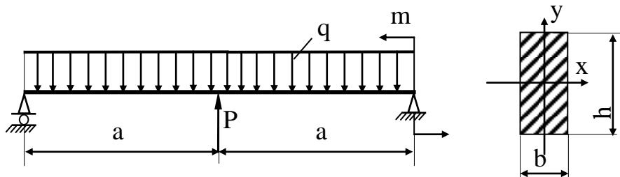
**Задача 7.** Стальная балка прямоугольного поперечного сечения ( $h = 20$  см,  $b = 10$  см) нагружена силой  $P$  и равномерно распределенной нагрузкой интенсивностью  $q$ . Определить допускаемую величину  $q$ , если:  $a = 2$  м;  $[\sigma] = 120$  Н/мм<sup>2</sup>.
