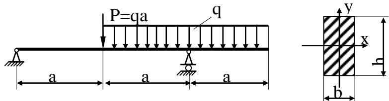
**Задача 8.** Определить максимальный прогиб, если  $q = 20$  кН/м;  $a = 1\text{м}$ ;  $E = 2 \cdot 10^5$  МПа;  $EJ_x = \text{const}$ , сечение балки - швеллер №14. Проверить жесткость балки, если  $[\gamma] = 0,003$  а.
