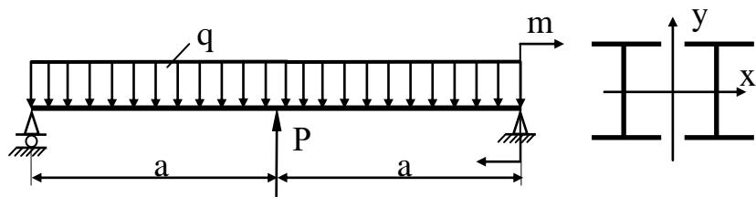
**Задача 6.** Проверить прочность балки, если  $[\sigma] = 160$  МПа.
