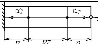
8. Определить допускаемую нагрузку  $P$  на систему симметричную систему стержней, если  $E_1 = 2 \cdot 10^5$  МПа,  $F_1 = 10 \text{ см}^2$ ,  $E_2 = 10^5$  МПа,  $F_2 = 20 \text{ см}^2$ ,  $[\sigma]_1 = 160$  МПа,  $[\sigma]_2 = 60$  МПа.
