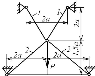
9. Стержень, изображенный на схеме, закреплен при  $t = -10$  °C. Определить напряжения при нагреве стержня на 100 °C при  $a = 0,2$  м. Модули упругости меди и стали равны  $E_1 = 1.1 \cdot 10^5$  МПа,  $E_2 = 2 \cdot 10^5$  МПа,  $F = 2 \text{ см}^2$ . Для стали коэффициент температурного расширения равен  $1.25 \cdot 10^{-5}$  1/град, для меди  $-2.5 \cdot 10^{-5}$  1/град.
