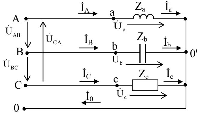
4. Рассчитать линейные и фазные токи и напряжения приемников. Построить топографические диаграммы, совмещенные с векторными диаграммами токов.
