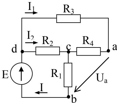
2. Составить систему уравнений по законам Кирхгофа для определения токов в ветвях схемы рисунке и записать ее в матричной форме.
