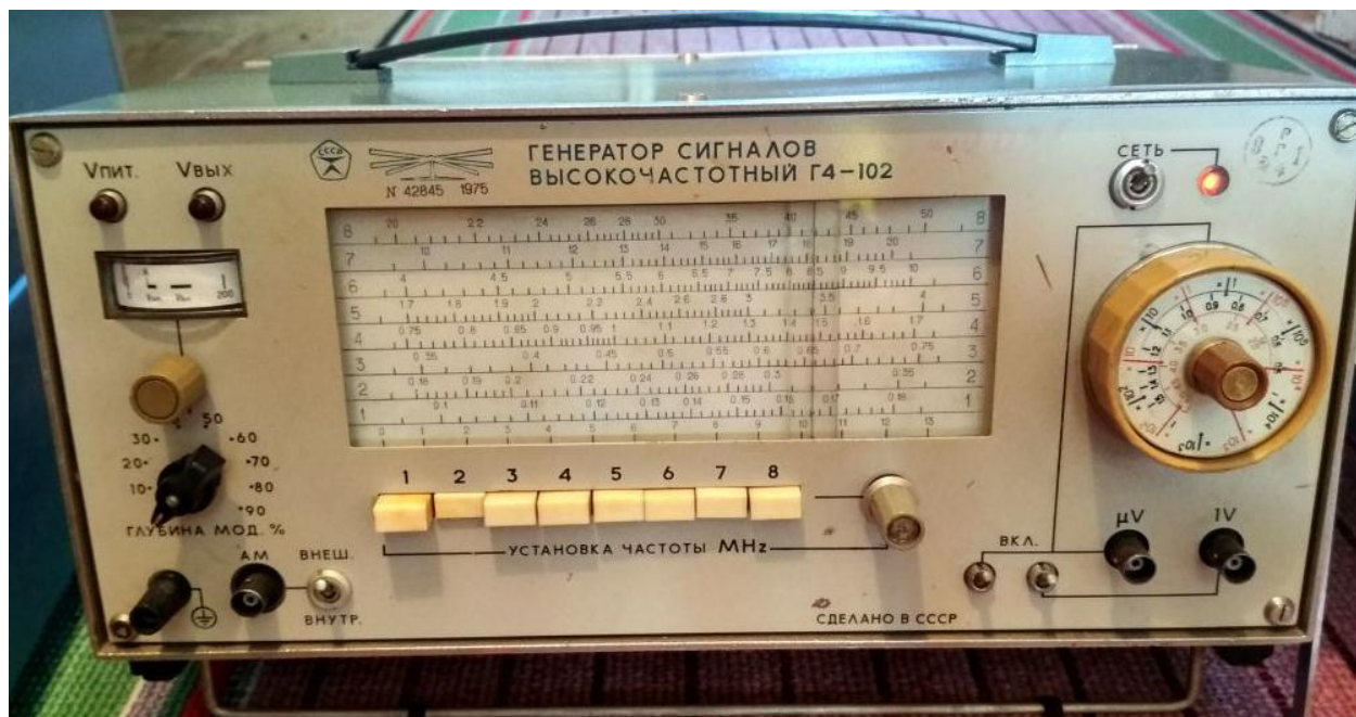
Рис. 9. Передняя панель высокочастотного измерительного генератора Г4-102
