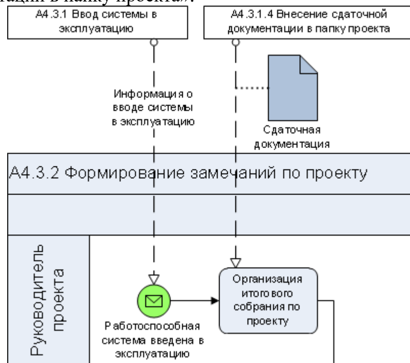
Рис. 9.28. Использование свернутого пула для обозначения источника потока сообщения
