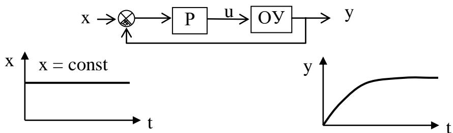
На схеме обозначены: Р – регулятор, ОУ – объект регулирования,  $t$  – время.
