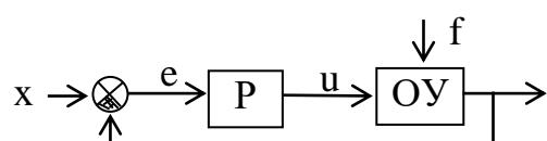
Данная схема (ОУ – объект управления) реализует принцип регулирования
