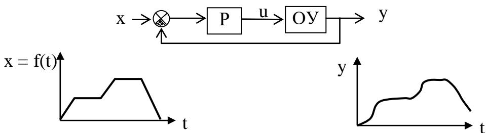
На схеме обозначены: Р – регулятор, ОУ – объект регулирования, t – время.
