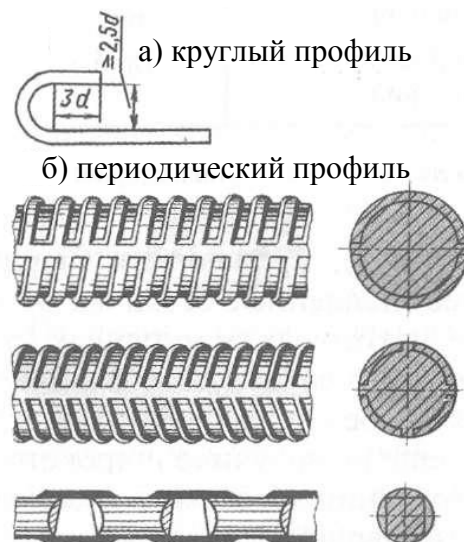
Рис. 16. Примеры арматуры различных профилей
