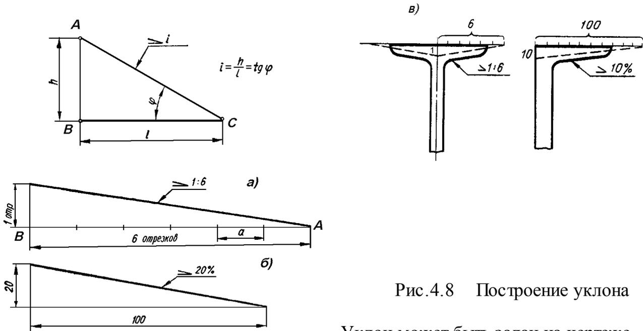
Рис.4.8 Построение уклона
