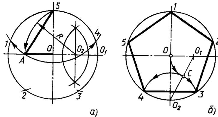
Рис.4.4 Два способа деления окружности на 5 и 10 частей
