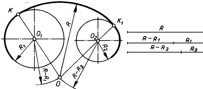
Из центров  $O_1$  и  $O_2$  провести дуги радиусов  $R-R_1$  и  $R-R_2$ . При пересечении этих дуг получаем точку  $O$  – центр дуги сопряжения. Соединить точки  $O_1$  и  $O_2$  с точкой  $O$  до пересечения с заданными окружностями. Точки  $K$  и  $K_1$  – точки сопряжения. Между точками  $K$  и  $K_1$  радиусом  $R$  проводим дугу сопряжения.
