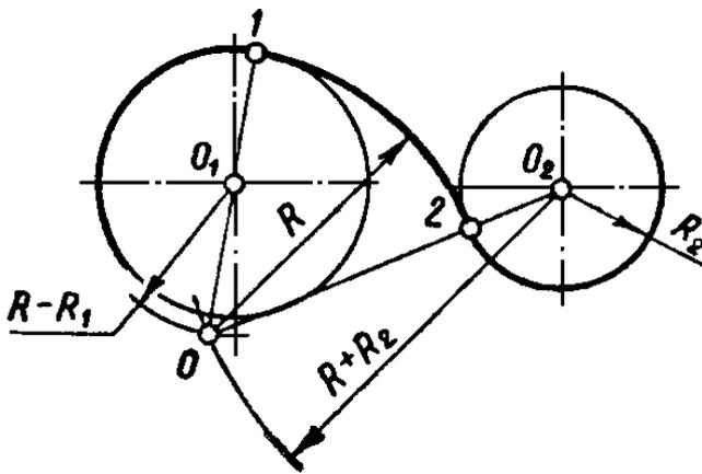
Из центров  $O_1$  и  $O_2$  провести дуги радиусов  $R-R_1$  и  $R+R_2$ . При пересечении этих дуг получаем точку  $O$  – центр дуги сопряжения. Соединяем точки  $O_1$  и  $O_2$  с точкой  $O$  до пересечения с заданными окружностями. Точки 1 и 2 – точки сопряжения. Между точками 1 и 2 радиусом  $R$  проводим дугу сопряжения.
